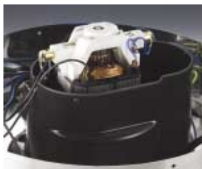
Εικ. 7-4: Αντικατάσταση ψηκτρών
